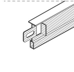
La estructura metálica se compone de perfiles primarios, de 3.7 m traquelados, en los que se insertan los perfiles secundarios de 1.2 y 0.6 m. El conjunto conforma una cuadrícula de 600x600 mm diseñada para la colocación de placas aislantes de diferentes tipos.
