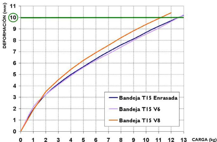
**Ensayo de Capacidad de Carga:** Se carga una bandeja sobre los perfiles T15 con masas calibradas de un kilo hasta conseguir el colapso de la bandeja. Ensayo realizado con Bandeja Lisa.
