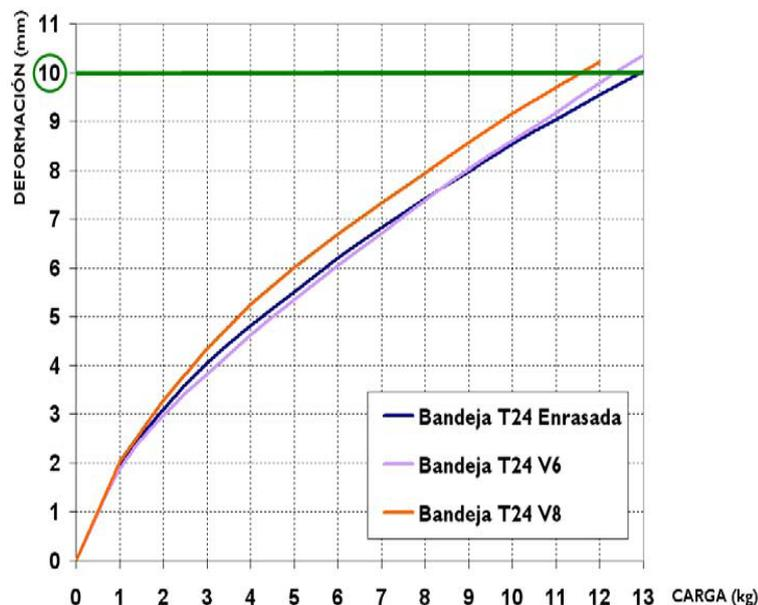
**Ensayo de Capacidad de Carga:** Se carga una bandeja sobre los perfiles T24 con masas calibradas de un kilo hasta conseguir el colapso de la bandeja. Ensayo realizado con Bandeja Lisa.
